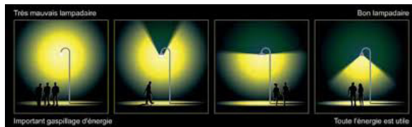
Forme d'éclairage à privilégier (Source: "Eclairage public - Protégeons notre biodiversité et nos paysages nocturnes", PNR Scarpe-Escaut)
