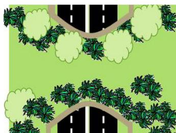
Schéma de principe : écoduc en forme d'entonnoir et continuité de la végétation (Source: "Guide BBP - les fiches techniques- Passages à Faune", www.biodiversite-positive.fr)
