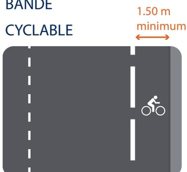
La largeur minimale recommandée est de 1,50 m hors marquage. En cas de présence de stationnement longitudinal, il est recommandé de créer une surlargeur de 0,5 m pour diminuer le risque d'emportierage.
